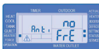
3. Wasserfrostschutzfunktion (YES/NO, Standard: YES)
