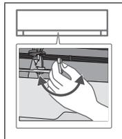
• Оно регулируется для поперечного направления вручную, как показано на рисунке.
