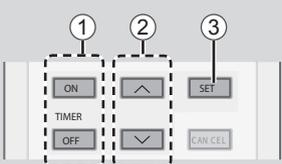
1 Выберите "ON" или "OFF" таймера (тип таймера)
